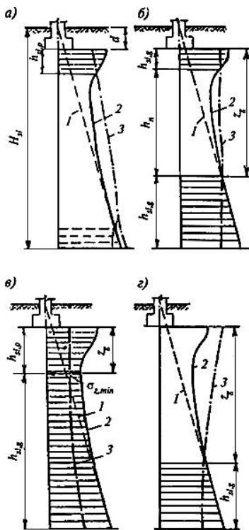
Рис.4. Схемы к расчету просадок основания
