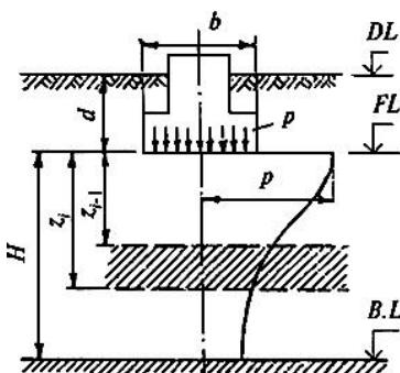
Рис.3. Схема к расчету осадок с использованием расчетной схемы основания в виде линейно деформируемого слоя
