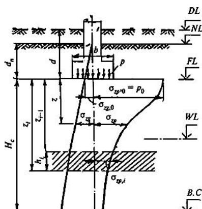
Рис.1. Схема распределения вертикальных напряжений в линейно деформируемом полупространстве
