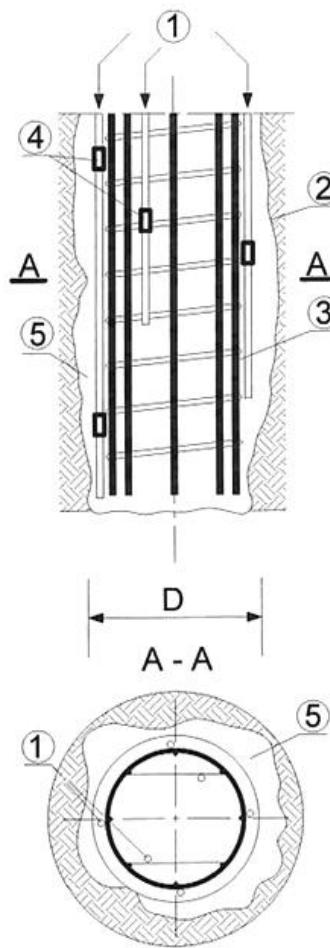
1 - трубы для подачи раствора и опрессовки; 2 - скважина, заполненная бетоном; 3 - арматурный каркас; 4 - клапаны; 5 - нагнетаемый раствор
