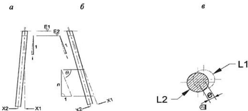
a) Вертикальная свая б) Наклонная свая в) Отклонение в плане
