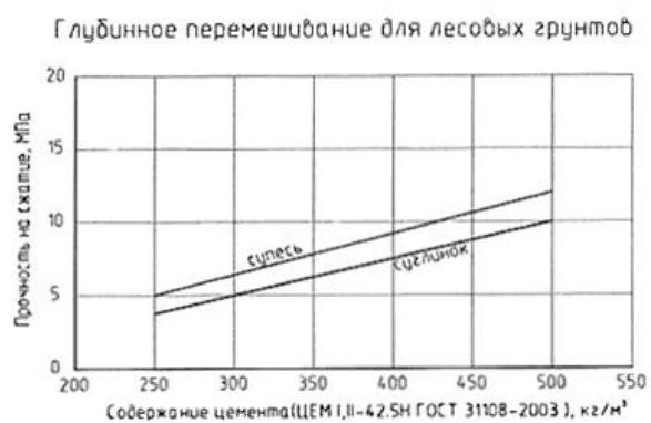
Рисунок Ф.3 - Зависимость прочности грунтоцемента от содержания цемента в 1 м<sup>3</sup> ГЦЭ
